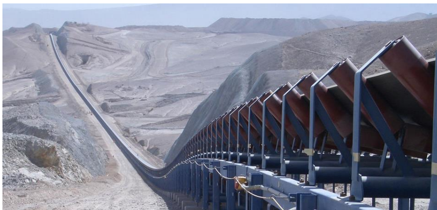
Рис.1. Магистральный конвейер для транспортировки вскрышных горных пород.
