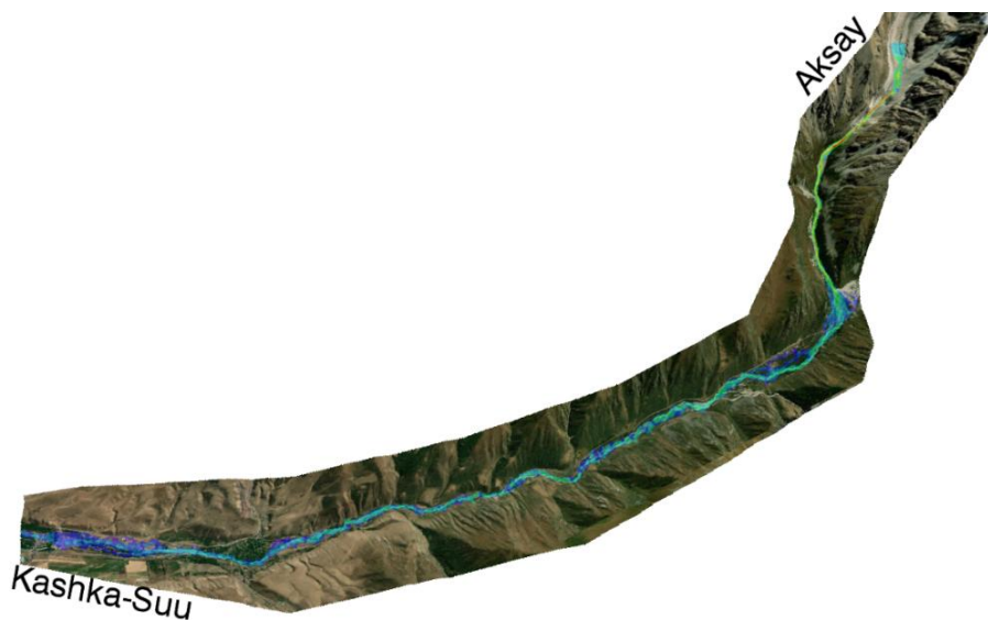
5-сүрөт - RAMMS программасында Аксай көлүнүн ачылышындагы зыян келтирген зонаны моделдештирүүнүн мисалы
