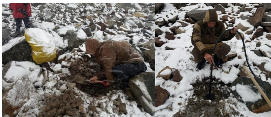
Рисунок 3.16. Фотодокументы процесса проходки для получения криосферной информации из пройденных шурфов и установка абляционных реек на левом борту заморененного участка ледника Кара-Баткак.
