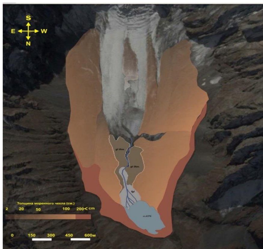
Рисунок 3.18. КФС спутниковый снимок толщины моренного чехла на заморененных участках показана тональностью оранжевого цвета для демонстрации языковой части морено-ледникового комплекса Кара-Баткак.
