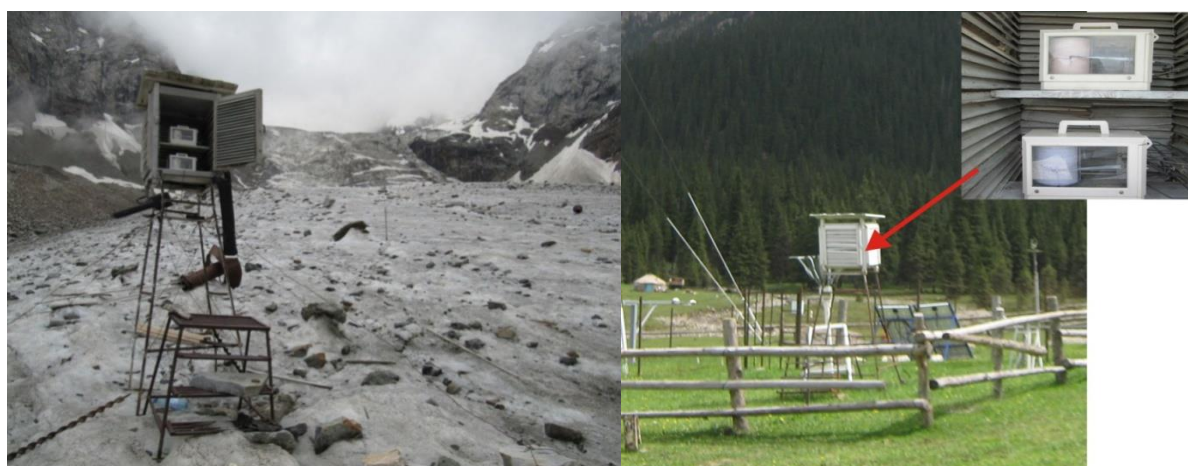
Рисунок 2.9. Фотодокумент. Метеорологическая будка с суточными самописцами температуры и влажности воздуха на леднике Кара-Баткак. Рисунок 2.10. ГМС Чон-Кызыл-Суу.
