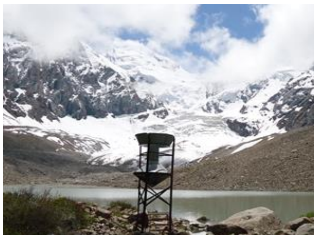
Рисунок 2.11. Фотодокумент. Суммарный осадкомер на леднике Кара-Баткак Основным источником приходной части бюджета ледника являются атмосферные осадки, выпадающие в холодный период года.
