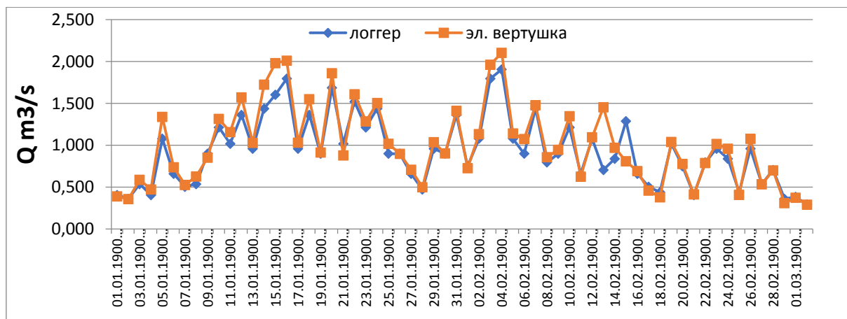
Рисунок 3.38. Среднесуточные расходы воды на ГП Кашка-Тор-исток за 2016 год (синим цветом представлена линия расходов воды, измеренных с помощью логгера, красным цветом - линия расходов воды, измеренных электронной вертушкой).
