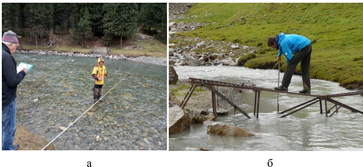
Рисунок 3.36. а) - измерение расходов и уровня воды на ГП Кашка-Тор-устье. б) - Кашка-Тор-исток с помощью электронной вертушки.
