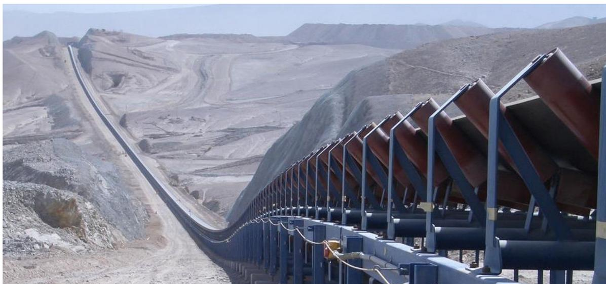
Рис.3.4. Магистральный конвейер для транспортировки вскрышных горных пород.
