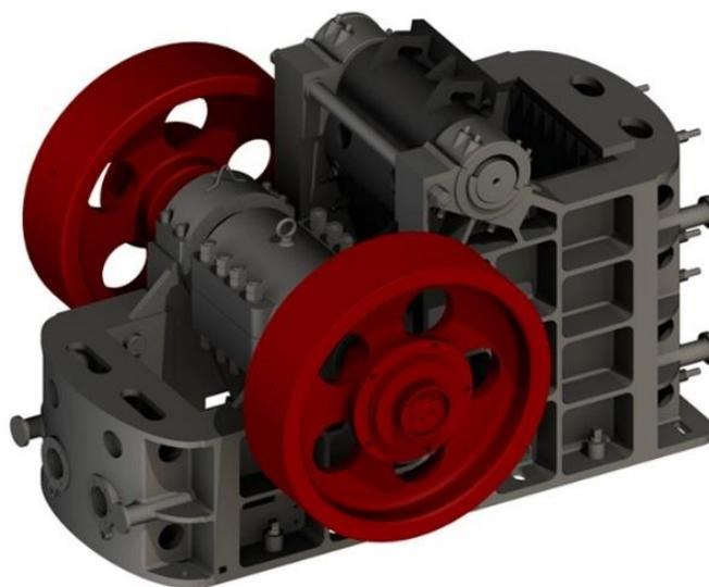
Рис. 3.3. Щековая дробилка СМД 118а.
