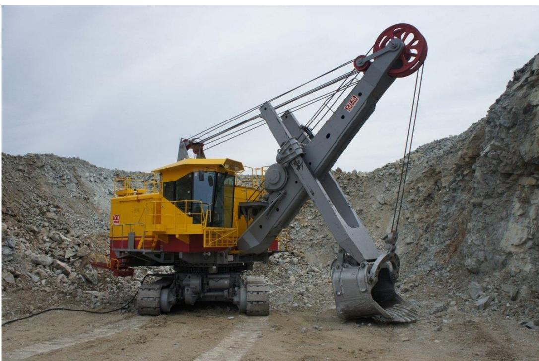
Рис.3.2. Экскаватор ЭКГ-5А
